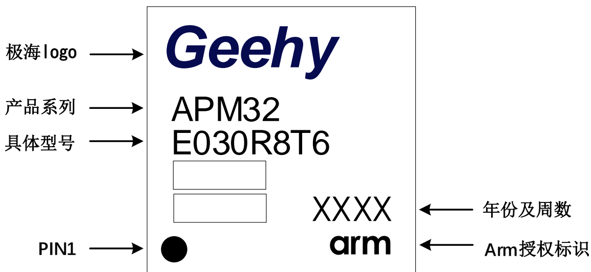
图 22 LQFP64 - 64 引脚，10 x 10mm 封装标识
