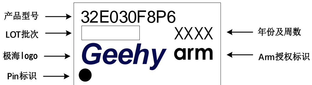
图 40 TSSOP20 – 20 引脚，4.4 x 6.5mm 封装标识
