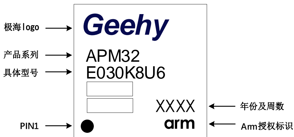
图 34 QFN32 - 32 引脚，5 x 5mm 封装标识
